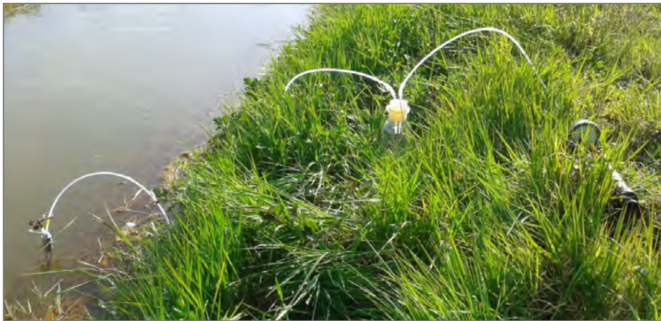
Figura 3.16. Dettaglio rispetto alla Figura 3.11. Lisimetro per l'estrazione dell'acqua interstiziale nel sedimento sommerso dell'alveo del Torrente Baccatoio (loc. Pollino, stazione VTINC), per il confronto con le caratteristiche dell'acqua corrente.
