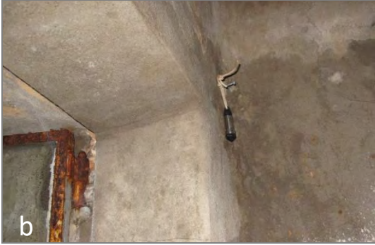
Figura 2.20. a) Sonda multiparametrica CTD-Diver per la misura di livello idraulico, temperatura e conducibilità elettrica dell'acqua a monte dello stramazzo; b) sonda Baro-Diver; c) misurazione manuale della portata.
