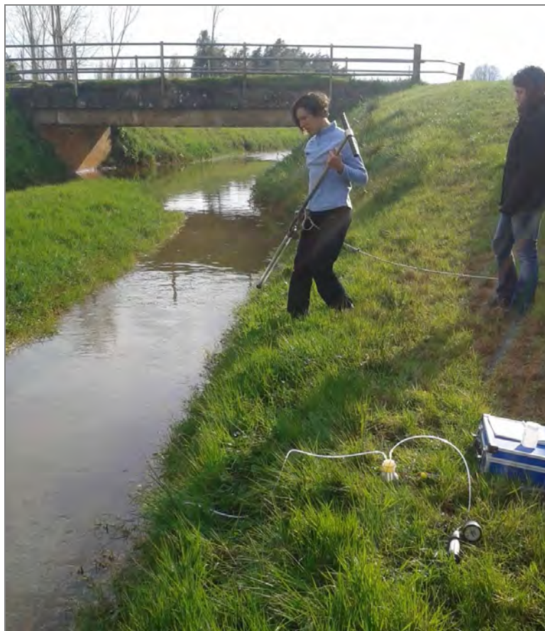
Figura 3.11. Campionamento tramite carotiere a pistone dei sedimenti di alveo del Torrente Baccatoio in località Pollino (stazione VTINC). In primo piano, il lisimetro con tubazioni per l'estrazione dell'acqua interstiziale nel sedimento sommerso.
