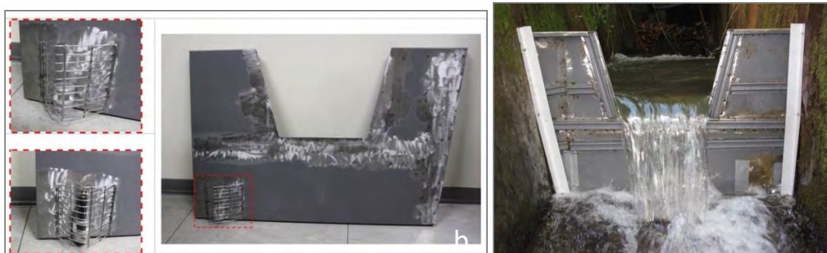
Figura 2.19. Lo stramazzo predisposto all'uscita della sorgente Molini di Sant'Anna (VSMSA): a) schema costruttivo con indicazione delle portate in base al livello idrico raggiunto sull'apertura; b) dispositivo per l'alloggiamento della sonda per l'acquisizione dei dati in continuo; c) messa in esercizio.
