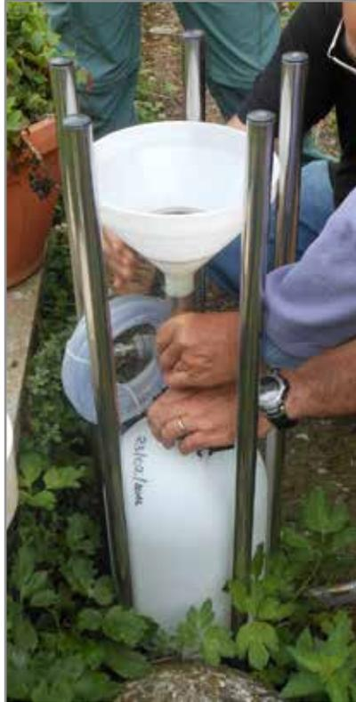
Figura 4.60 – Pluviometro per il campionamento per l'analisi isotopica delle piogge del bacino del Torrente Baccatoio.
