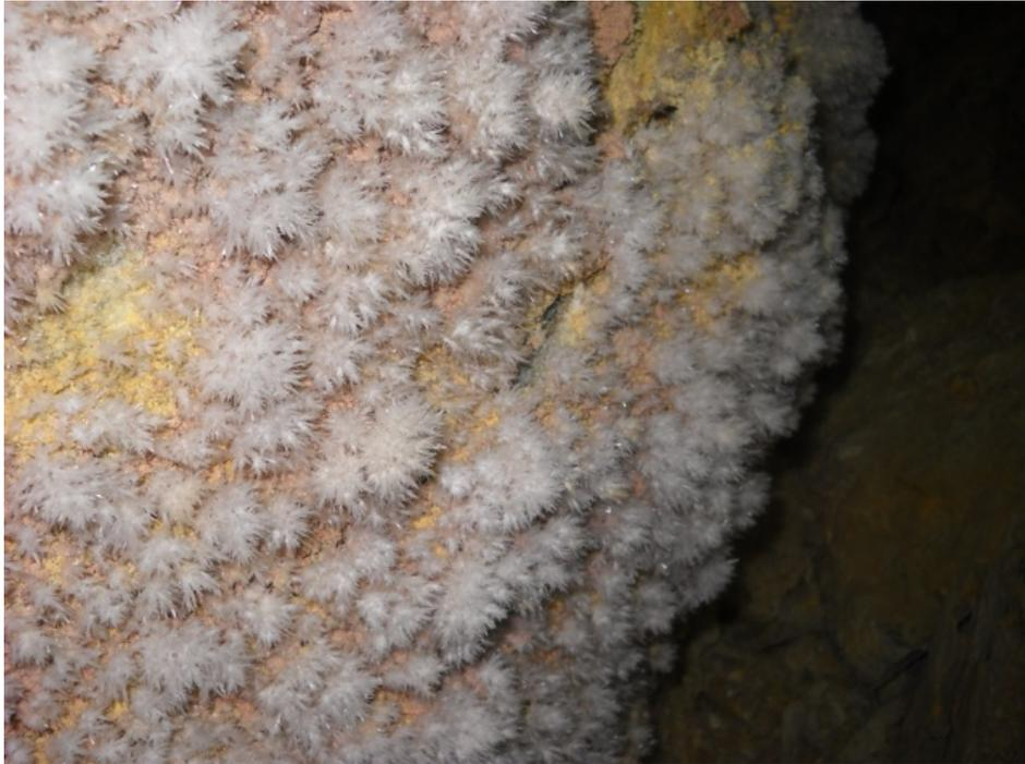
Figura 4.5 – Estesa formazione di gesso sulle pareti di gallerie minerarie (Miniera di M.te Arsiccio).
