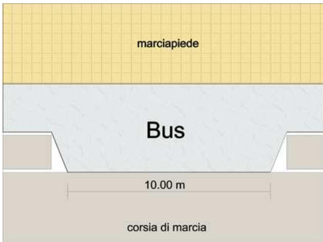
In presenza di parcheggi in linea lungo la carreggiata stradale, l'inserimento di piattaforme di sosta che sporgono dal bordo del marciapiede consente una buona sicurezza e una maggiore visibilità per il pedone in attesa; evita inoltre il parcheggio delle auto in corrispondenza della fermata.
