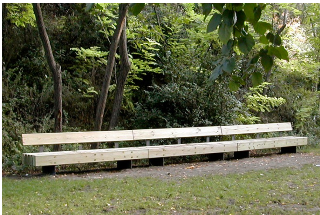
Panchina modulare in assi di pino trattati per esterno con elementi di fissaggio in metallo.
