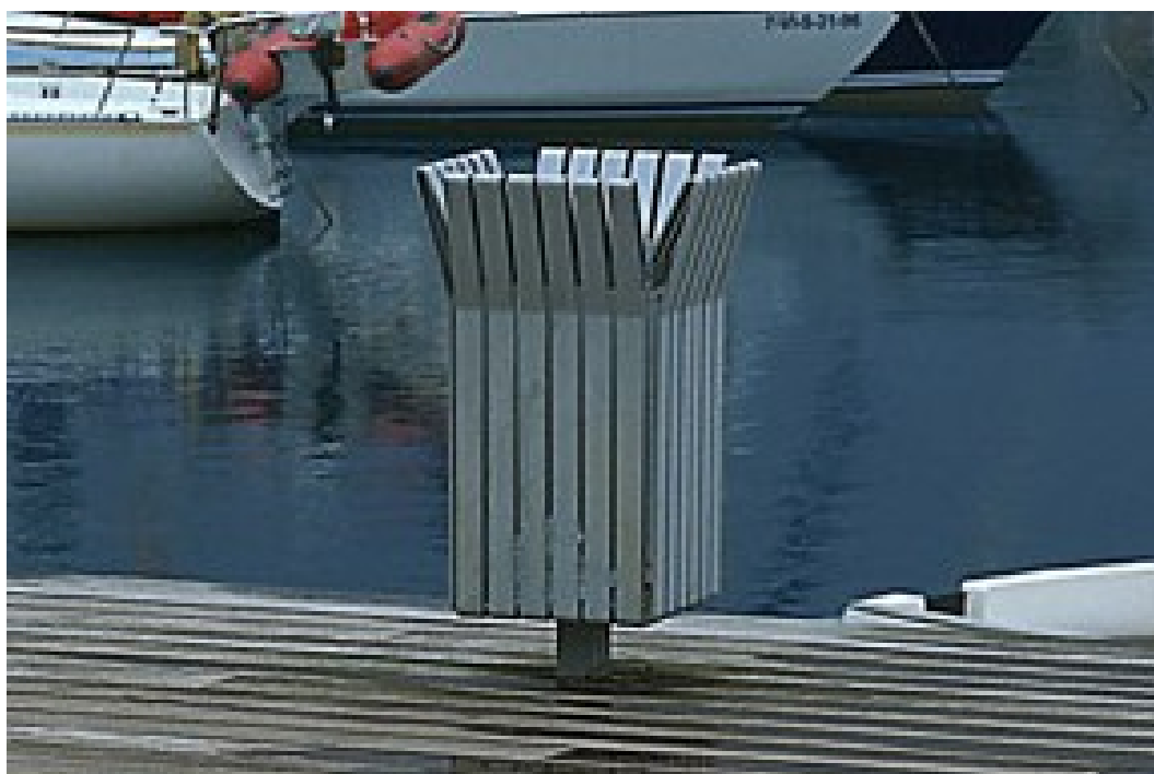
Cestino portarifiuti con supporto centrale e strisce di acciaio galvanizzato
