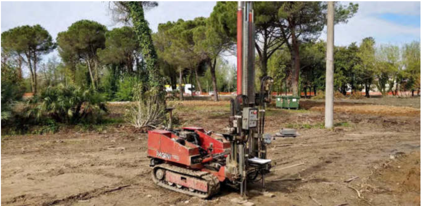
Figura 2 INDAGINE PENETROMETRICA DPSH-1 ESEGUITA SUL SITO
