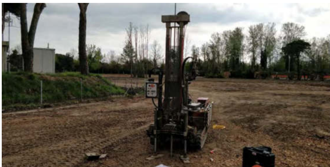
Figura 7 INDAGINE PENETROMETRICA DPSH4 ESEGUITA SUL SITO
