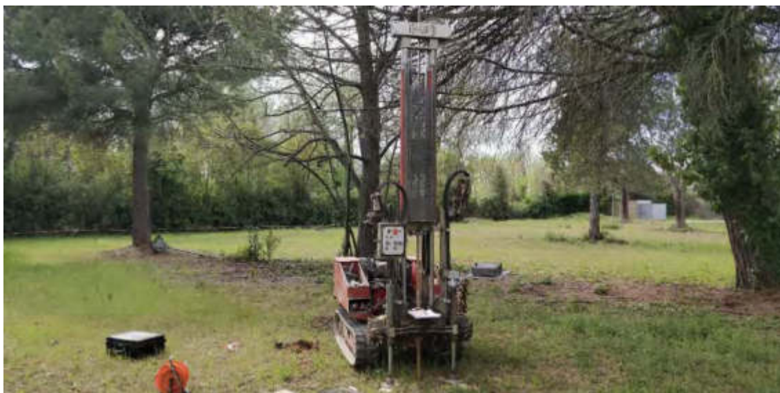
Figura 6 INDAGINE PENETROMETRICA DPSH3 ESEGUITA SUL SITO
