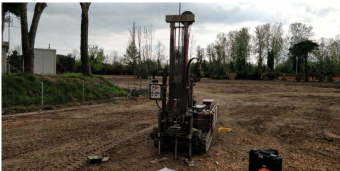
Figura 5 INDAGINE PENETROMETRICA DPSH-4 ESEGUITA SUL SITO
