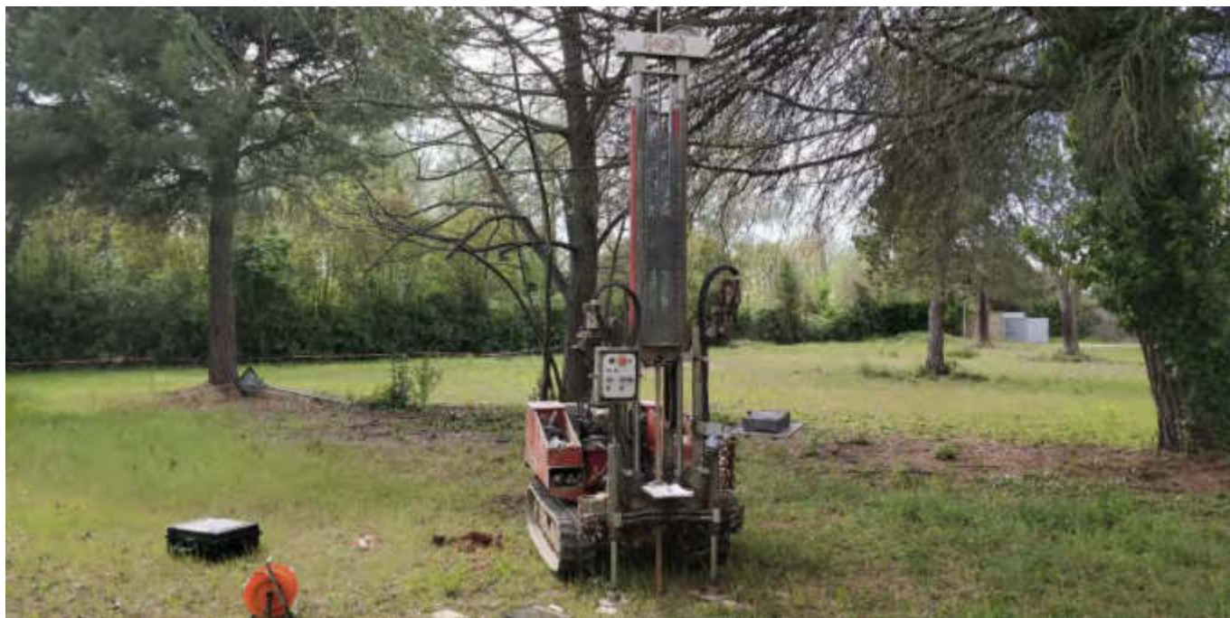
Figura 4 INDAGINE PENETROMETRICA DPSH-3 ESEGUITA SUL SITO
