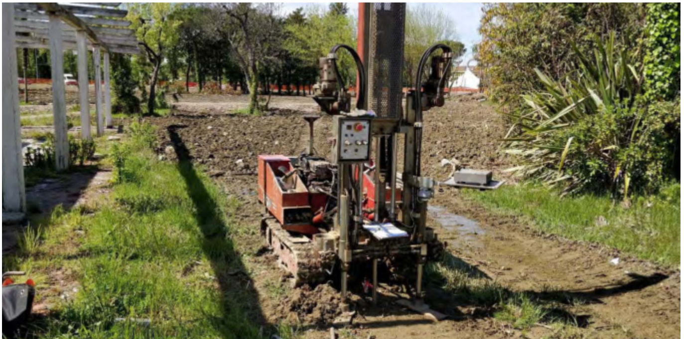
Figura 3 INDAGINE PENETROMETRICA DPSH-2 ESEGUITA SUL SITO
