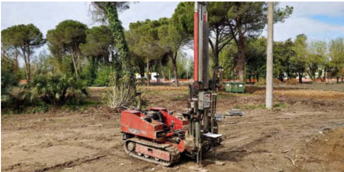
Figura 5 INDAGINE PENETROMETRICA DPSH2 ESEGUITA SUL SITO
