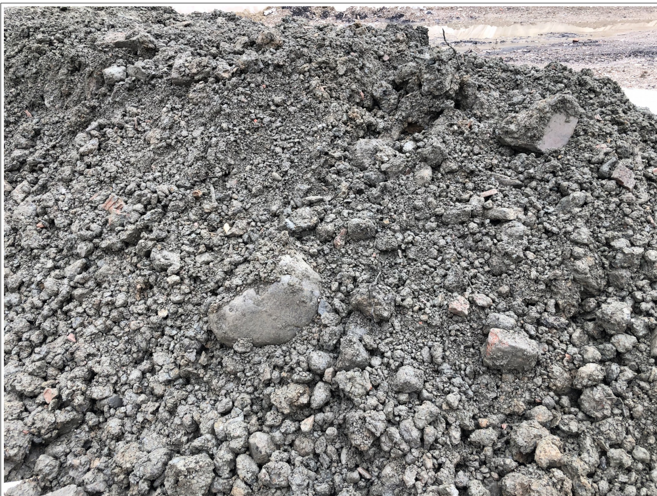
Foto 5: particolare del cumulo presenza di sassi, mattoni, cemento con granulometria superiore ai 20mm
