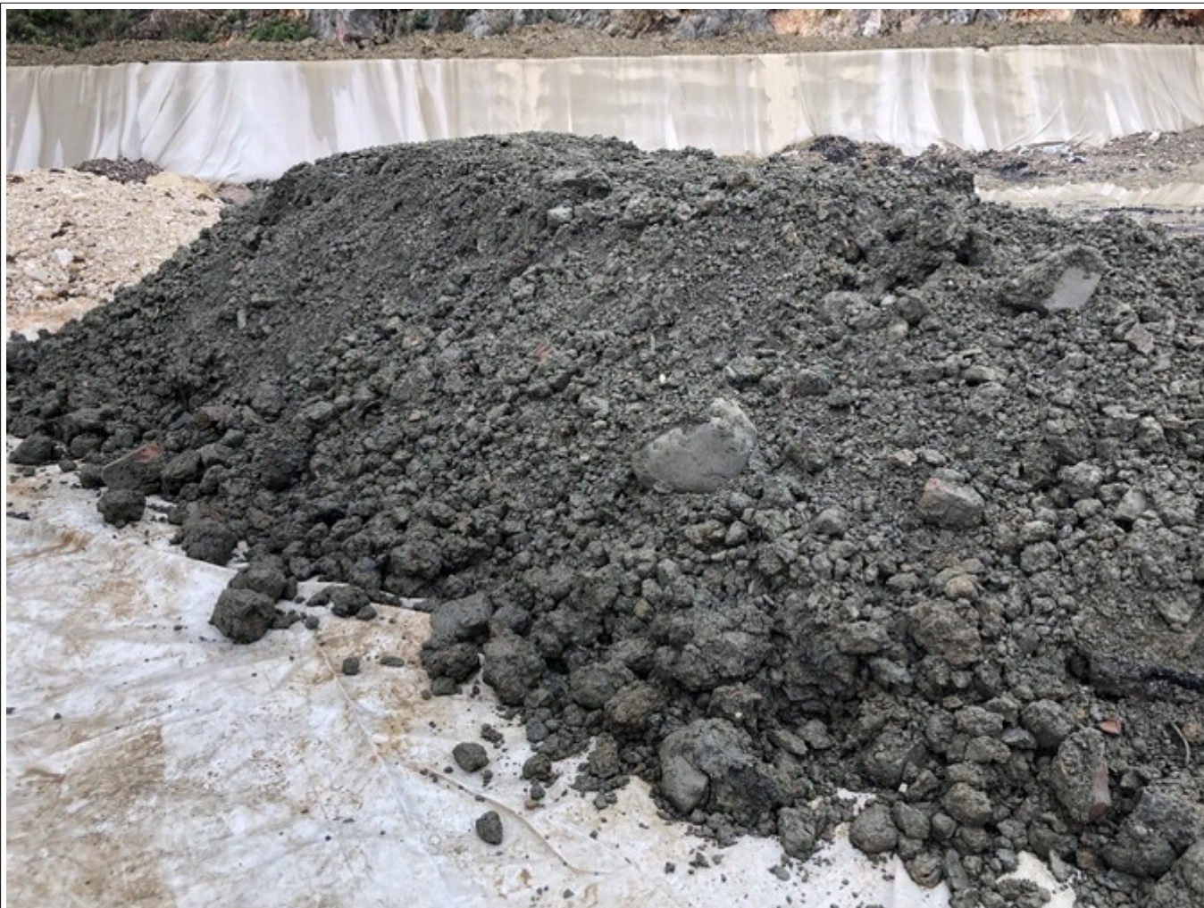
Foto 6: particolare del cumulo presenza di sassi, mattoni, cemento con granulometria superiore ai 20mm
