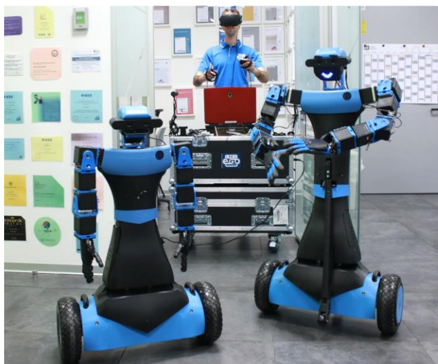
Piattaforma Alter-Ego: versione Alter-Ego bassa (a sinistra), versione Alter-Ego alta (a destra) e la postazione del pilota.
